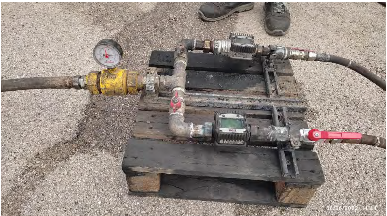
Particolare del sistema di iniezione – Contabilizzazione su doppia linea
